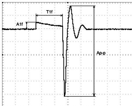
Форма импульса при подключенной нагрузке Z
