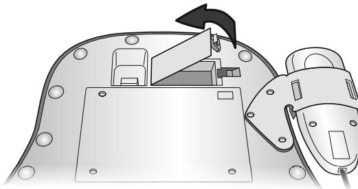
1. Снимите крышку батарейного отсека и извлеките использованные элементы питания.
